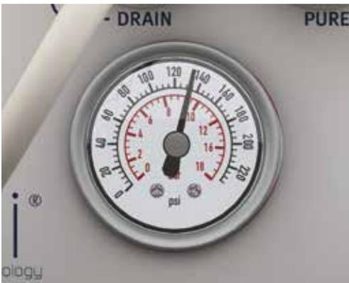
Nach dem Filterwechsel wieder den Pumpendruck am Manometer an der Rückseite überprüfen.
