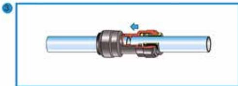
Das Rohr bis zum Anschlag einstecken. Das Halteelement fixiert das Rohr im Verbinder. Durch den O-Ring wird eine dichte Verbindung hergestellt.
